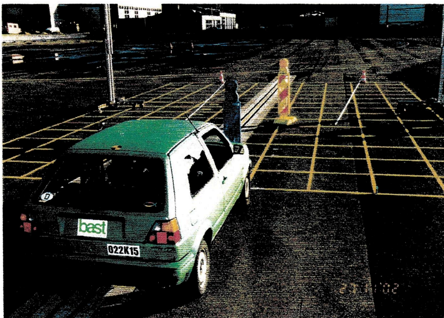
Anfahrssituation für Prüfung der passiven Sicherheit
